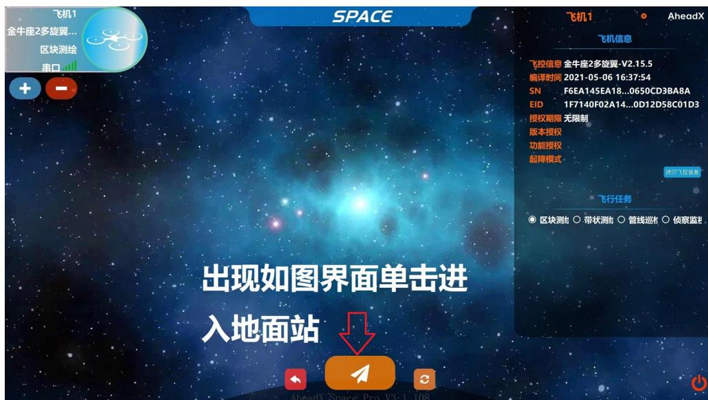
直到出现如图界面单击黄色飞机图标后进入飞行控制界面
