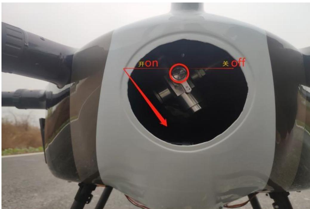
开启阀门以后地面站会实时显示气瓶压力（注意检查压力是否足够进行此次飞行）
