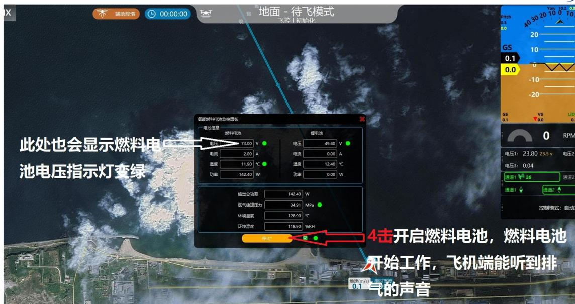
注意! 电堆温度低于15摄氏度禁止自动飞行, 所有指示灯皆为绿色, 右侧功耗无明显变化才可以进行任务!
