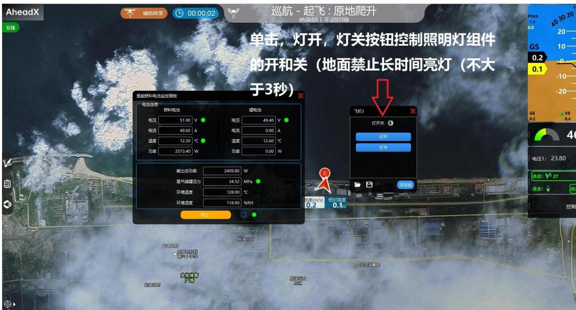
通过点击执行面板上的开关，控制负载设备的使用（如探照灯）
